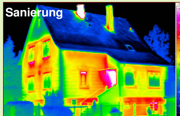
... die Aufnahme mit der Wärmebildkamera zeigt rot und gelb die Schwachstellen eines Hauses ... So sollte es nach der Sanierung nicht mehr aussehen !
